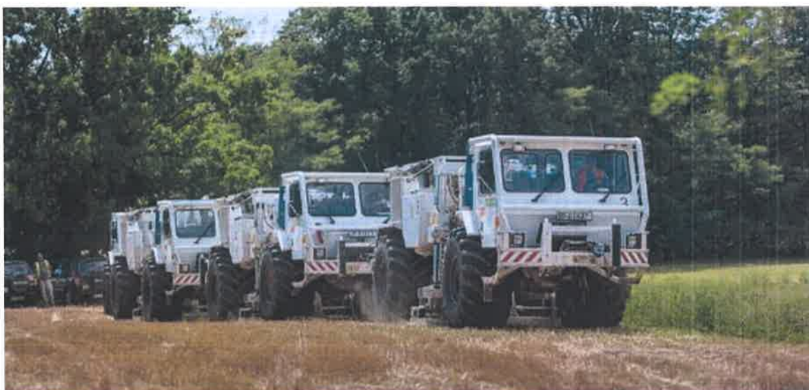
Slika 2.1 Vibratorska flota (3 vibratora na točki izvora)
